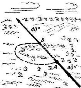
Второй способ, применяемый при отсутствии видимости через препятствие, заключается в том, что обход совершается по прямым направлениям, азимут и длина которых строго фиксируются для выхода на заданное направление.
